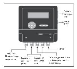
Система m2 состоит из центрального блока, который может контролировать до 16 датчиков или входных преобразователей, которые обычно размещаются в заданных точках охлаждаемой зоны (в охлаждаемых витринах, морозильных аппаратах, холодильных камерах), заводских помещениях или детекторах утечки газа, а также может координировать работу до 99 контроллеров типа EKC 201/301/331/414/531.
