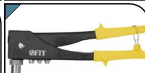
Заклёпочник Для крепления вытяжных алюминиевых заклёпок. 4 быстросменных насадки, пружинный рычаг для выброса сердечника от заклёпок, рукоятка с виниловым покрытием. № D, мм L, мм 32003 2.4-3.2-4.0-4.8 240
