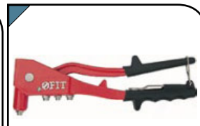
Заклёпочник Для крепления вытяжных алюминиевых заклёпок. 4 быстросменных насадки, пружинный рычаг для выброса сердечника от заклёпок, рукоятка с покрытием из PVC пластика. № D, мм L, мм 32015 2.4-3.2-4.0-4.8 255
