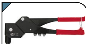
Заклёпочник Для крепления вытяжных алюминиевых и стальных заклёпок. 4 быстросменных насадки, пружинный рычаг для выброса сердечника от заклёпок, рукоятка с покрытием из PVC пластика. Для профессионального использования. № D, мм L, мм 32032 2.4-3.2-4.0-4.8 265
