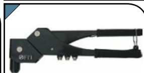
Заклёпочник Для крепления вытяжных алюминиевых заклёпок. 4 быстросменных насадки, пружинный рычаг для выброса сердечника от заклёпок, рукоятка с покрытием из PVC пластика. № D, мм L, мм 32001 2.4-3.2-4.0-4.8 240
